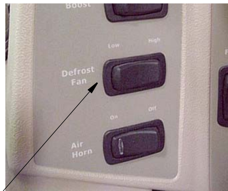
Defrost Fan Switch
